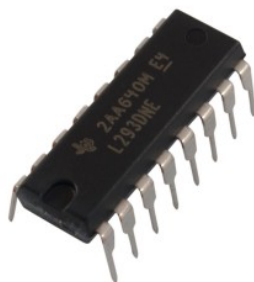
Obrázek 2.12: Můstkový budič L293D
